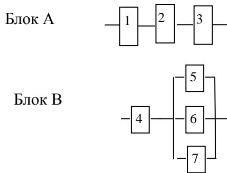
При отказе блока он подлежит полной замене, причем стоимость замены блока  $A$  составляет  $C_1$ , блока  $B$  –  $C_2$  единиц стоимости. Предполагается, что за период времени  $T$  замененный блок не выйдет ещё раз из строя.
