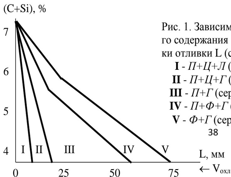
Рис. 1. Зависимость структуры чугунов от суммарного содержания углерода и кремния и толщины стенки отливки L (скорости охлаждения  $V_{\text{охл}}$ ):
