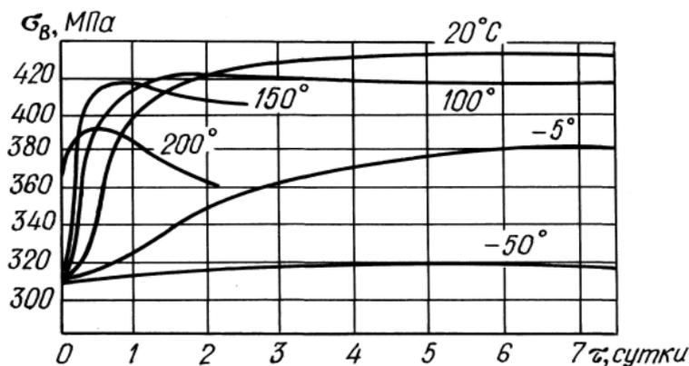
Рис. 2. Зависимость прочности дуралюмина от режима старения
