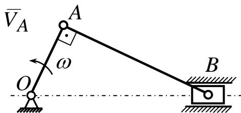
2. В кривошипно-ползунном механизме кривошип  $OA$  вращается с угловой скоростью  $\omega = 2 \text{ рад/с}$ . Длина кривошипа  $OA = 3 \text{ см}$ , длина шатуна  $AB = 4 \text{ см}$ . В момент времени, когда кривошип и шатун образуют прямой угол, скорость ползуна  $B$  равна ...
