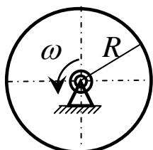
1. Маховое колесо радиусом  $R = 0,5 \text{ м}$  вращается равноускоренно из состояния покоя; через  $t = 10 \text{ с}$  угловая скорость колеса равна  $\omega = 10 \text{ рад/с}$ . Касательное ускорение  $W_r$  точки, лежащей на ободе колеса, равно ...
