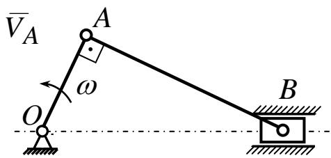
2. В кривошипно-ползунном механизме кривошип  $OA$  вращается с угловой скоростью  $\omega = 2 \text{ рад/с}$ . Длина кривошипа  $OA = 3\text{см}$ , длина шатуна  $AB = 4\text{см}$ . В момент времени, когда кривошип и шатун образуют прямой угол, скорость ползуна  $B$  равна ползуна  $B$  равна ...
