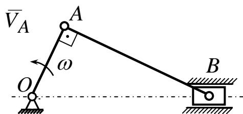
2. В кривошипно-ползунном механизме кривошип  $OA$  вращается с угловой скоростью  $\omega = 2 \text{ рад/с}$ . Длина кривошипа  $OA = 3 \text{ см}$ , длина шатуна  $AB = 4 \text{ см}$ . В момент времени, когда кривошип и шатун образуют прямой угол, скорость ползуна  $B$  равна ползуна  $B$
